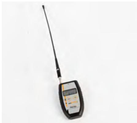
Les deux MiniTRACE y S10S et S100S sont également disponibles en **version radio (S10R et S100R)**, ce qui permet d'intégrer les radiamètres à un réseau de communication ShortLINK ou SkyLINK, d'une **portée maximale de 20 kilomètres**.
