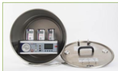
Combiné à une chambre Radon, AlphaGUARD permet de caractériser l'émanation radon des matériaux et d'étalonner tout équipement de mesure du radon.
