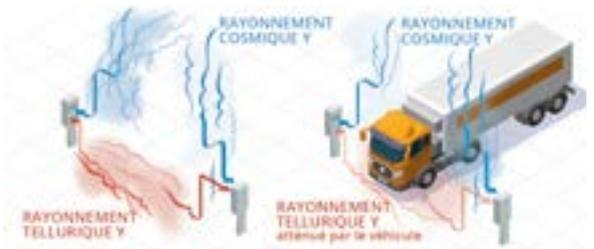
SaphyGATE G utilise un algorithme spécifique, conçu pour compenser la variation causée par l'atténuation due à la masse du véhicule et de son chargement. Cette technologie offre de meilleures performances de détection, en particulier pour les sources radioactives de faible activité. Elle permet de rejeter la plupart des fausses alarmes, lesquelles constituent un problème récurrent pour les portiques classiques (avec des conséquences humaines et technologiques).
