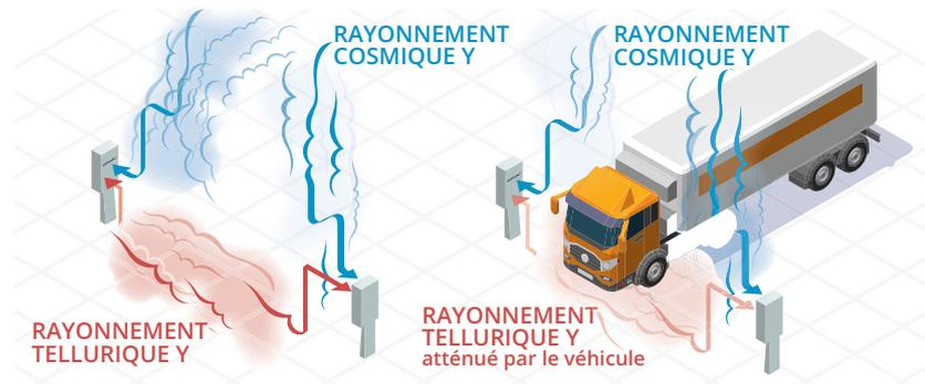
SaphyGATE G utilise un algorithme spécifique, conçu pour compenser la variation causée par l'atténuation due à la masse du véhicule et de son chargement. Cette technologie offre de meilleures performances de détection, en particulier pour les sources radioactives de faible activité. Elle permet de rejeter la plupart des fausses alarmes, lesquelles constituent un problème récurrent pour les portiques classiques (avec des conséquences humaines et technologiques).
