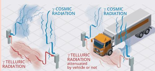
Dans le cadre du développement de sa gamme de portiques SaphyGATE (G & GN), Bertin a conçu un algorithme spécifique pour compenser l'atténuation du bruit de fond Gamma dû à la masse du véhicule et de son chargement. Cette technologie offre ainsi de meilleures performances de détection, en particulier pour les sources radioactives masquées, et limite le taux de fausses alarmes en identifiant notamment les matières radioactives naturelles.
