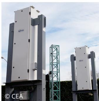
Développé en partenariat avec le Commissariat à l'Energie Atomique et aux Energies Alternatives (CEA), le SaphyGATE GN est un **portique nouvelle génération** capable de détecter les **sources radioactives Gamma et Neutron sans utiliser de gaz  $^3\text{He}$** .
