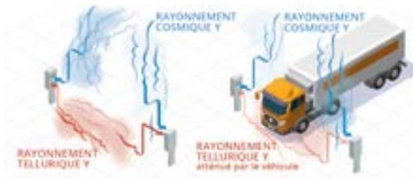
Dans le cadre du développement de sa gamme de portiques SaphyGATE (G & GN), Bertin a conçu un algorithme spécifique pour compenser l’atténuation du bruit de fond Gamma dû à la masse du véhicule et de son chargement. Cette technologie offre ainsi de meilleures performances de détection, en particulier pour les sources radioactives masquées, et limite le taux de fausses alarmes en identifiant notamment les matières radioactives naturelles.
