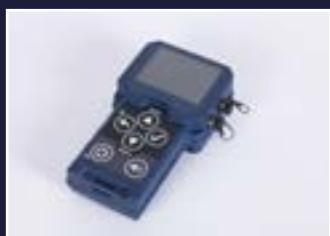
Le SaphyRAD S dispose d'une fonction de simulation, spécialement adaptée aux entraînements. Ainsi, le moniteur reproduit un événement radiologique, faisant fluctuer l'affichage des données présentée par l'appareil. Enfin, un simulateur reconstitue les effets d'un nuage de contamination alpha/beta, permettant à l'utilisateur de se former en conditions réelles sans utiliser de sources radioactives.
