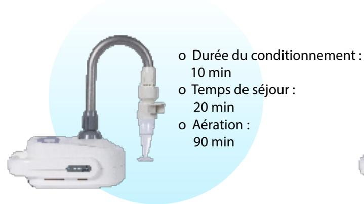
Décontaminer l'unité à l'aide de la technologie de vapeur de peroxyde d'hydrogène (HPV) et activer le mode de décontamination.
