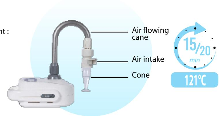
Autoclaver l'air flow intake et l'air intake à 121°C, 15 psig (1 bar) pendant 15-20 min.
